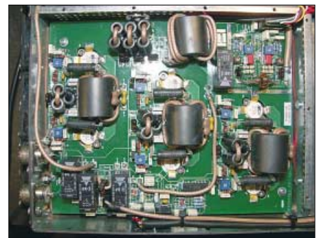
Bild 2: Unter der Haube: Der eigentliche HF-Teil besteht aus drei parallelgeschalteten Gegentaktstufen.
